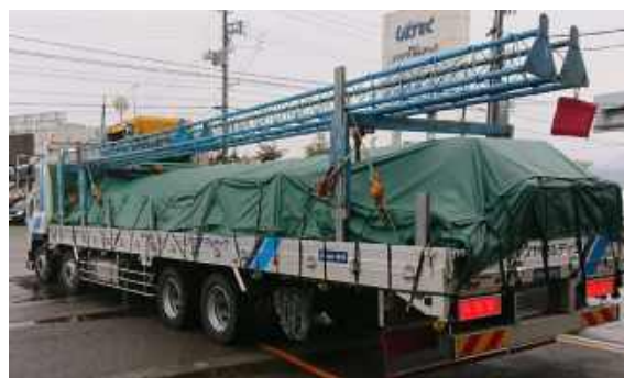
現場加工（成型機・アンコイラー・天秤）積載
