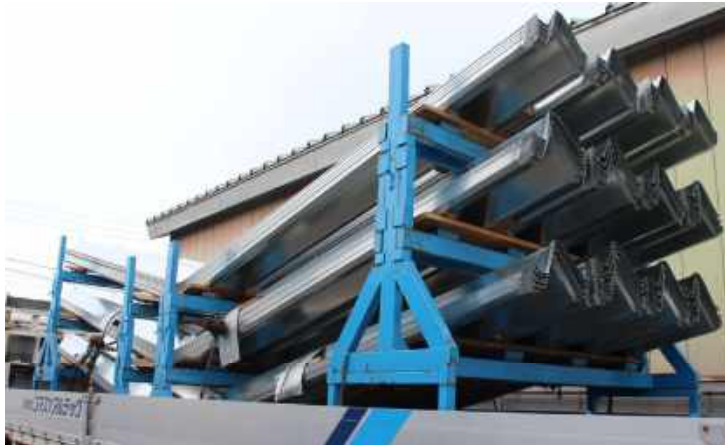
V-300 t=1.6 ラジアル・ジョイント工法
