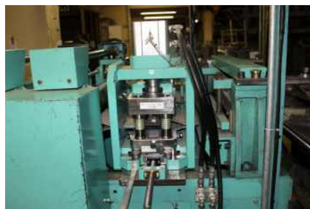
立平葺切り欠き用定尺切断機装備改造
