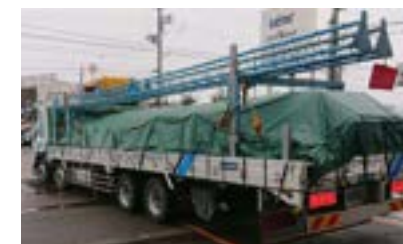
現場加工 (成型機・アコイラー・天秤) 積載
