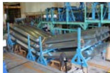
V-300 t=1.6 ラジアル加工・ジョイント加工
