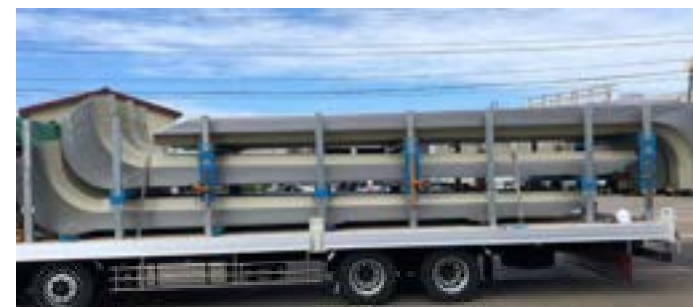
ハゼ II 型 ラジアル工法 3段積載
